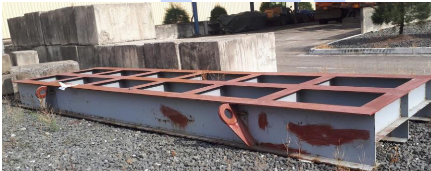
Khung chất tải và tải thử 150 tấn
